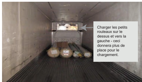
La longueur réelle est de 12' de long. Une fois que les petits rouleaux sont chargés sur le dessus et vers la gauche, la marchandise sur palette peut être chargée sur le côté droit. Cubez comme 144L x 48l x 96H.
