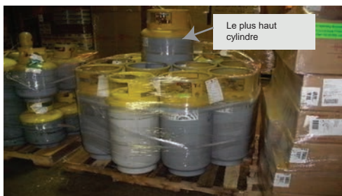
Les dimensions réelles s'appliquent au point le plus élevé de la marchandise. L x l x H (taille du cylindre le plus haut)
